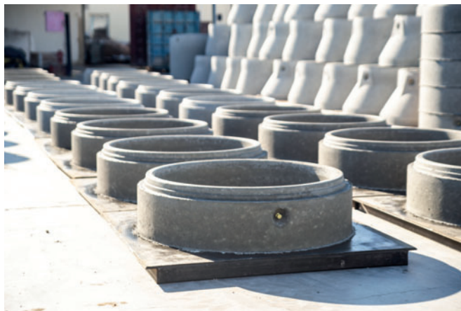
Шаровые анкера, прочно замоноличенные в бетон, образуют основу для безопасного обращения вплоть до перемещения на стройплощадке. © Vojtěch Peša
