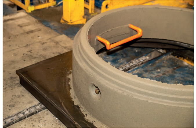
Помимо подъемных анкеров лестничные скобы передаются на машину и замоноличиваются также автоматически и независимо от времени цикла. © Vojtěch Peša
