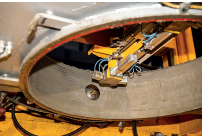
Решающий аспект автоматизации для компании Zábójník s.r.o.: автоматическая передача шаровых анкеров на формовочную установку. © Vojtěch Peša
